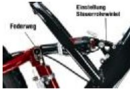
Beim RFC.01 haben Sie die Möglichkeit am Hinterbau mit einem Schnellspanner den Federweg einzustellen. Über die Verstellleiste am Hauptrahmen können Sie die Geometrie (Steuerrohrwinkel) einstellen.
