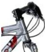
Bei Rädern mit Aheadset Lenkungslagersystem wird mit Hilfe des Vorbaus auch das Lenkungslager eingestellt. Wird der Vorbau verändert, muss das Lager neu justiert werden. Eine Höhenregulierung des Vorbaus ist nur durch Veränderung der Zwischenringe, den sogenannten Spacern, oder durch Umdrehen des Vorbaus, möglich.
