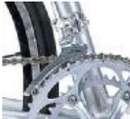
Kettenschaltungen an ROTWILD MTBs/Rennrädern werden bereits beim Hersteller bzw. bei Ihrem Fachhändler genau eingestellt. Durch die Dehnung des Schaltzuges kann jedoch, besonders in der ersten Zeit, eine Nachjustierung erforderlich sein. Bei Kettenschaltungen ist es wichtig zu berücksichtigen, dass Sie nicht sämtliche theoretisch möglichen Gänge fahren sollten. Wenn die Kette nämlich zu schräg läuft, ist der Verschleiss an Kette und Zahnradern sehr hoch und der Wirkungsgrad herabgesetzt.
