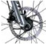
Wenn Sie Bremsbeläge erneuern müssen, verwenden Sie ausschliesslich gekennzeichnete und zum Bremskörper passende Bremsbeläge. Wenn neue Bremsbeläge montiert wurden, machen Sie zunächst Probefahrungen unter ungefährlichen Bedingungen.
