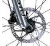
**Achtung:** Geöffnete Anschlüsse oder undichte Leitungen führen dazu, dass die Bremswirkung stark abfällt. Suchen Sie bei Undichtigkeiten des Systems oder Knicken in den Leitungen ihren Fahrradhändler auf.
