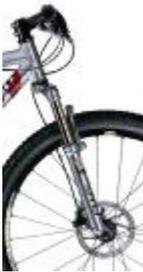
Alle ROTWILD Modelle sind für eine Federgabel ausgelegt. Für eine optimale Funktion muss diese auf Fahrergewicht und Einsatzzweck eingestellt werden. Hinweise dazu finden Sie im jeweiligen Rahmenkapitel. Überlassen Sie bitte alle Wartungsarbeiten Ihrem Fachhändler.
