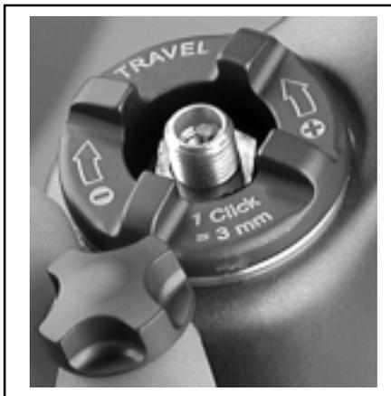
Fig. 2 TALAS Air Top Cap Knob & Schrader Valve
