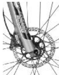
Bremsen einen grösser werdenden Handhebelweg. Dieser kann bei den meisten Typen an der Bedieneinheit, dem Bremshebel, mit einer Schraube nachgestellt werden. Scheibenbremsen werden im Betrieb extrem heiss. Vermeiden Sie deshalb auch noch einige Zeit nach dem Bremsen jede Berührung der Bremsscheibe. Die hydraulischen Leitungen müssen stets unbeschädigt und geschlossen bleiben.
