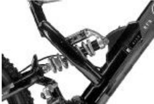
Je nach Fahrergewicht, Sitzhaltung und Einsatzbereich muss die Charakteristik des Stossdämpfers eingestellt werden. Beim Aufsitzen auf das Bike muss das Federbein der Hinterradschwinge bereits leicht eintauchen. Beim Durchfahren eines Schlaglochs entspannt sich die Feder - die Schwinge
