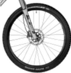
Laufräder sollten "rund laufen". Ein Laufrad mit Höhen- oder Seitenschlag kann im Hinblick auf eine berechenbar gute Bremswirkung zum Sicherheitsrisiko werden. Doch auch sonst kann eine Unwucht im Laufrad – besonders bei hohen Geschwindigkeiten – zu instabilem Fahrverhalten und damit zu einer Gefährdung führen. Laufräder sollten eine gleichmässige und hohe Spannung der Speichen besitzen. Lassen Sie dies regelmässig kontrollieren.
