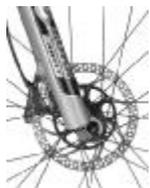
Wenn Sie Bremsbeläge erneuern müssen, verwenden Sie ausschliesslich gekennzeichnete und zum Bremskörper passende Bremsbeläge. Wenn neue Bremsbeläge montiert wurden, machen Sie zunächst Probefahrungen unter ungefährlichen Bedingungen.
